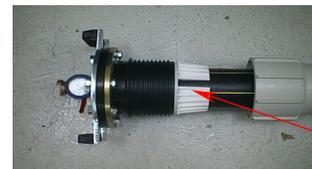
Bague de crantage : Partie large face au raccord
